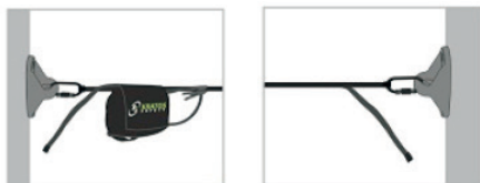
Cas 1 : Il existe des points d'ancrages (EN 795 Type A)
