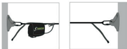
Případ 1: Na místě jsou kotevní body (EN 795 typ A)
