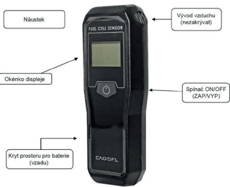
Dechový detektor alkoholu na bázi technologie palivových článků (Fuel Cell)
